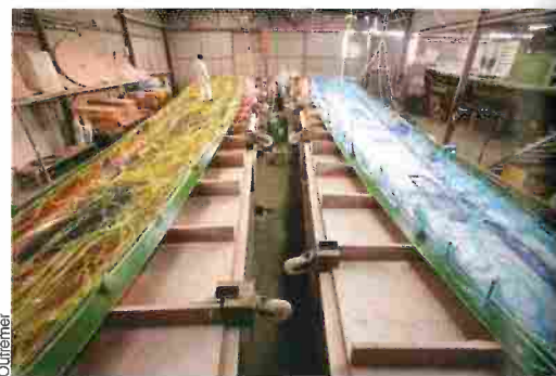
Fabrication chez Outremer des moules spécifiques à la version No Limit.
